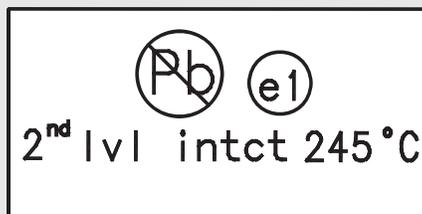
Cualquier trabajo nuevo o reparación en productos preferentemente ecológicos se debe realizar con soldadura sin plomo y pasta sin plomo adecuadas, como se establece en la siguiente tabla:
